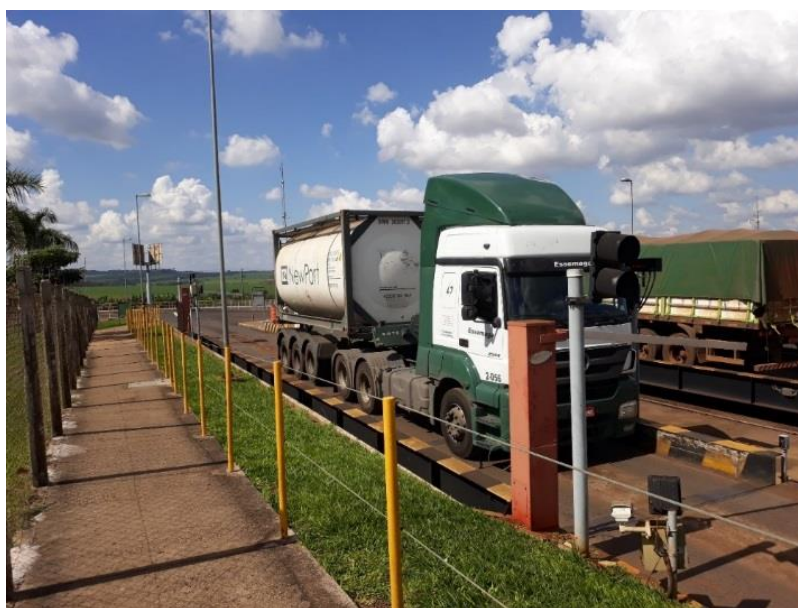
Foto 4.4: Veículo ISOTanque para transporte de DDOS. Fonte Própria.
