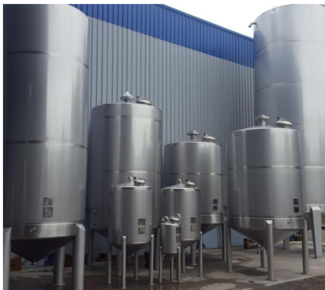
Foto 5.6: Tanques de armazenamento de ácido graxo. Fonte: Recifer.
