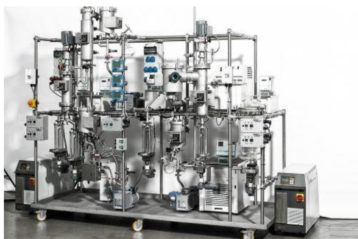
Figura 2.4: Destilador Molecular modelo: KDL 5 UIC GmbH. Utilizado em muitas pesquisas de destilação molecular de DDOV. Fonte: https://www.uic-gmbh.de/en/solutions-products/laboranlagen.php , site do fabricante.
